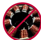
Расплавление изоляции обмоток компрессора
